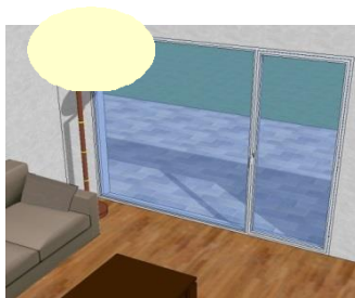
Un éclairage de type halogène à proximité du vitrage ou orienté vers le vitrage.
